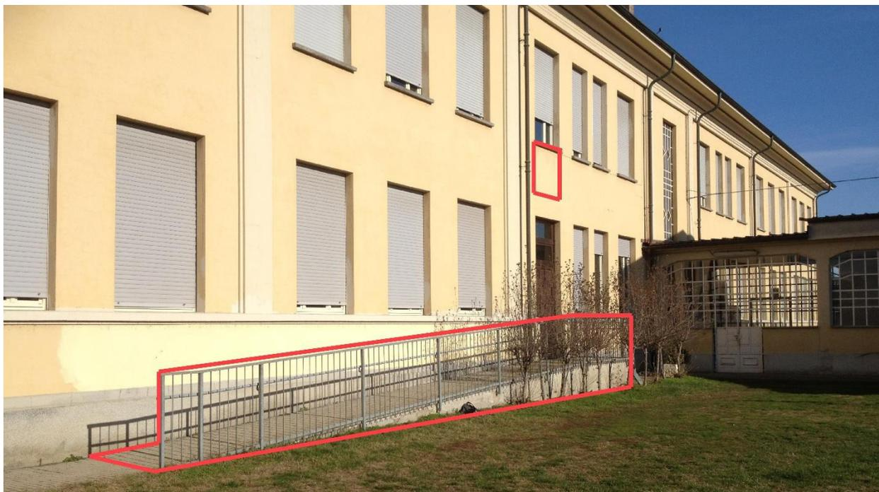
*Vista sud-ovest: demolizione di porzione della rampa pedonale e del parapetto finestra sul prospetto sud per il nuovo ascensore*
